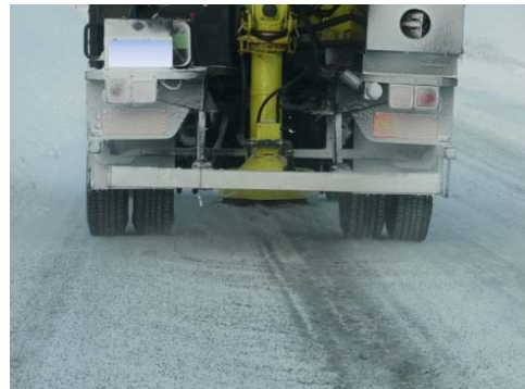
写真10 試作機による防滑材加熱水混合散布状況
