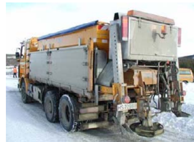
写真3 ノルウェーにおける防滑材加熱水混合散布に対応した機械の一例
