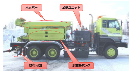
写真4 防滑材加熱水混合散布に対応した試作機
