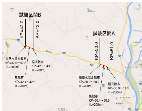
図 18 実道試験の散布区間
