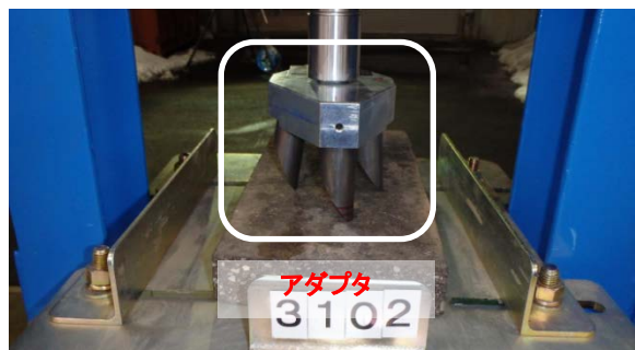
写真-27 舗装供試体試験を用いた状況
