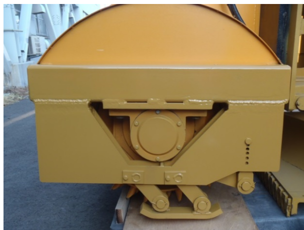
写真-19 破碎部に装備した破碎深さ制御機能
