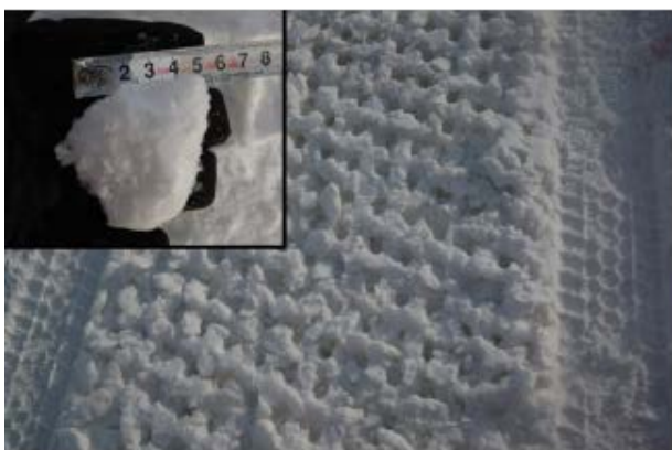
写真-18 破碎部による雪氷路面の破碎状況と発生した雪氷片
