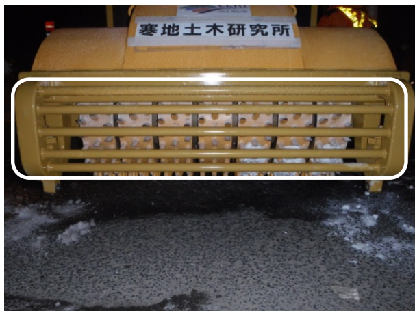
写真-21 巻き込み防止ガード
