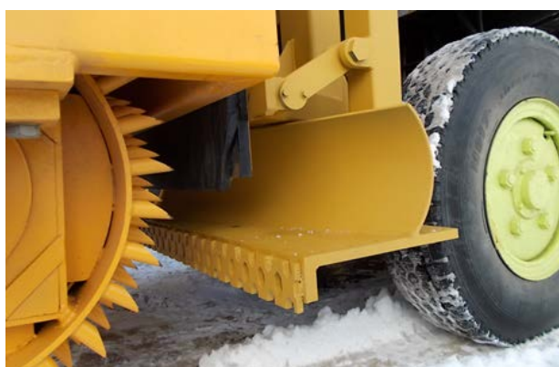
写真-22 破砕部フレーム下部に装着した排雪部
