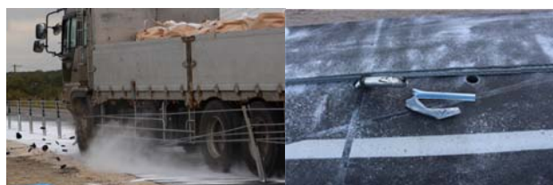
写真8 衝突時の状況 (左) と破断した支柱 (右)
