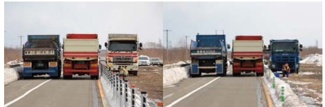
写真4 大型車同士のすれ違い状況(左：ワイヤロープ式防護柵区間、右：ラバーポール区間)
