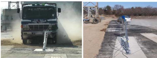
写真3 車両衝突時の状況
