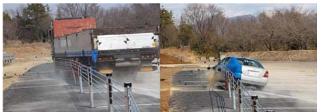
写真7 車両衝突時の状況
