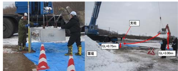
写真21 支柱衝突実験状況 (左:支柱と重錘、右:重錘吊り上げ状況)
