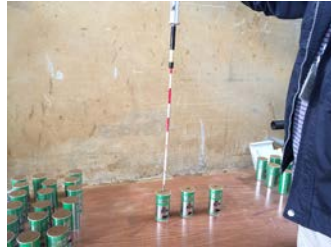
写真4 モールド缶での貫入土壌硬度計測
