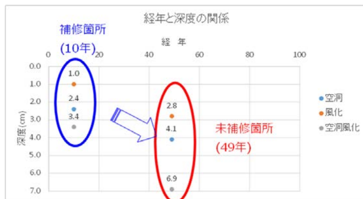
図13 補修箇所・未補修箇所の空洞・風化の平均深度
