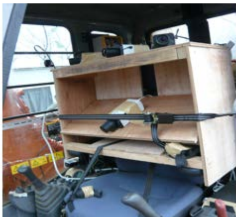
図-21 車載カメラ4台設置状況
