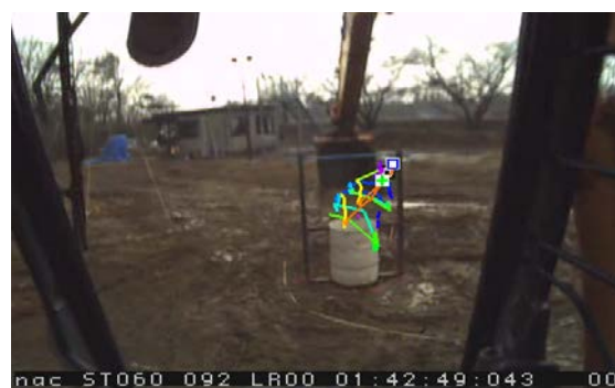
図-10 操作経験 1 年未満のオペレータの視線軌跡
