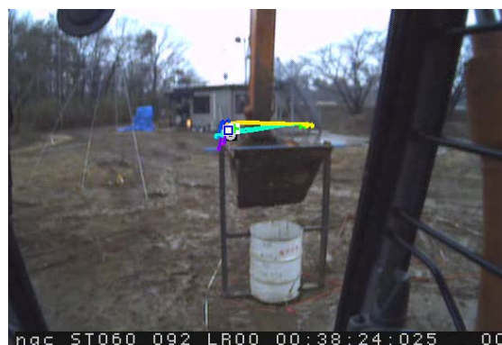
図-11 操作経験 5 年以上のオペレータの視線軌跡
