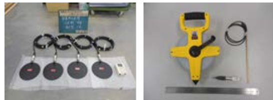
(d) 土圧計及び水位計
