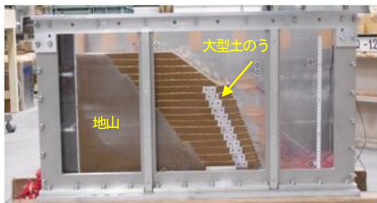
写真-4.3 模型地盤（補強土タイプ）
