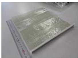
写真-4.5 壁面材と補強材
