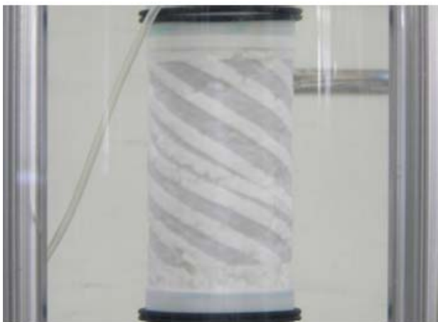
写真-3.15 試験1による繰返し载荷後の状況 (コア材 No.11、締固め度 Dc=98\% )
