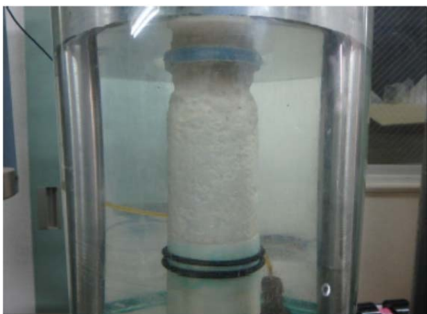
写真-3.14 試験1による繰返し载荷後の状況 (ロック材 No.11、締固め度 Dr=90\% )
