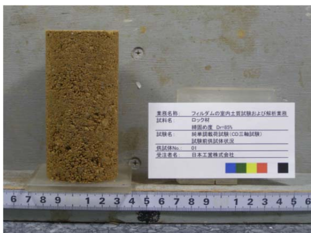
写真-3.5 ロック材 No. 1 (締固め度 D_r=85\% )
