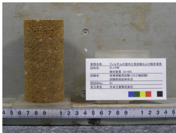
写真-3.7 ロック材 No. 1 (締固め度 D_r=95\% )
