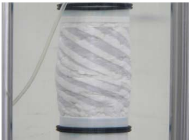
写真-3.17 試験 2 による単調载荷後の状況 (コア材 No.11、締固め度 Dc=98\% )
