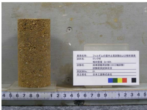
写真-3.6 ロック材 No. 1 (締固め度 D_r=90\% )
