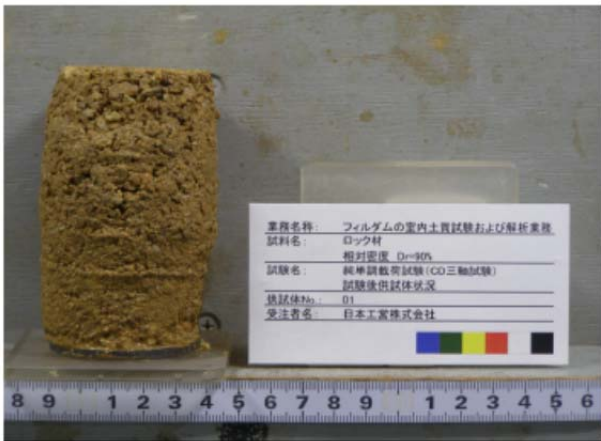
写真-3.10 CD試験後の状況 (ロック材 No. 1、締固め度 D_c=90\% )
