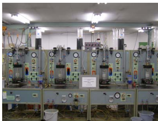
写真-3.3 静的三軸圧縮試験装置
