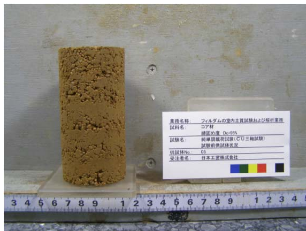
写真-3.8 コア材 No. 5 (締固め度 D_c=95\% )
