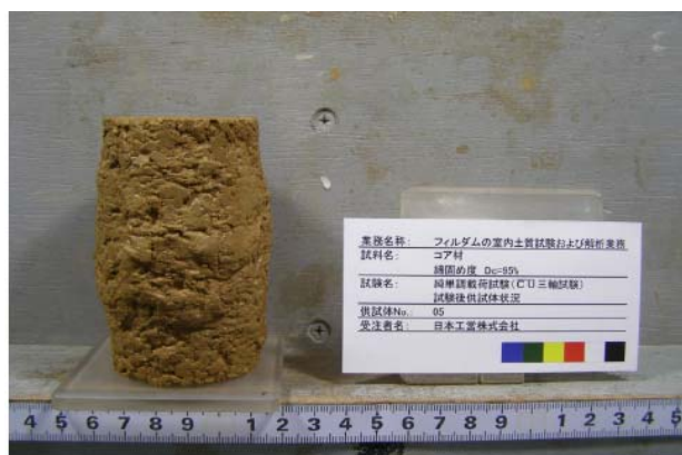
写真-3.12 CU試験後の状況 (コア材 No. 5、締固め度 Dc=95%)
