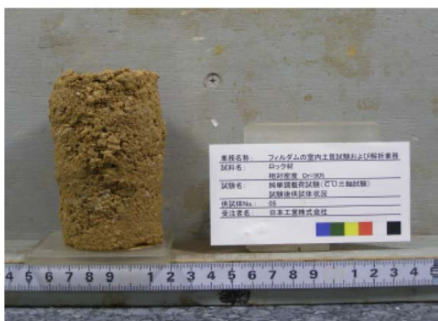
写真-3.11 CU試験後の状況 (ロック材 No. 5、締固め度 Dc=90%)
