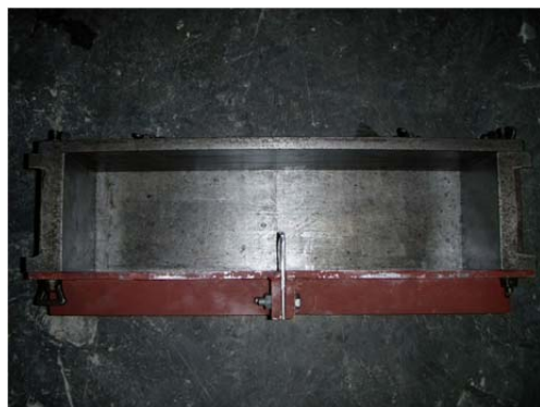
写真-2.3 破壊エネルギー試験用供試体作製に用いた鋼製型枠
