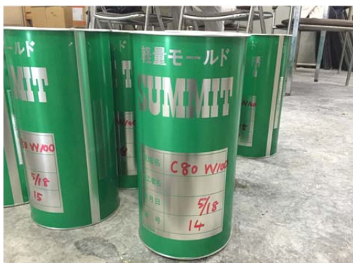
写真-2.2 圧縮強度試験用供試体の作製に用いた軽量型枠
