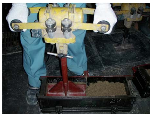
写真-2.4 破壊エネルギー試験用供試体の作製
