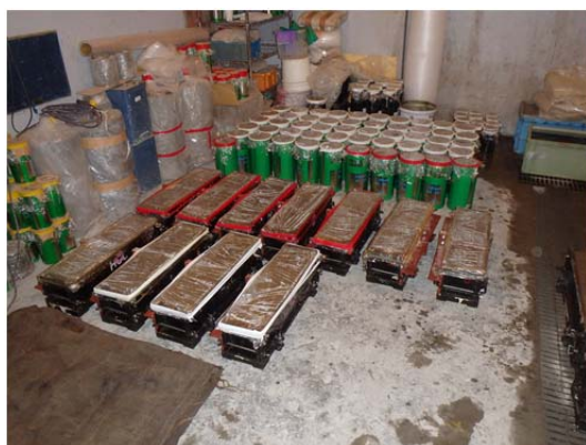
写真-2.5 破壊エネルギー試験用供試体の養生
