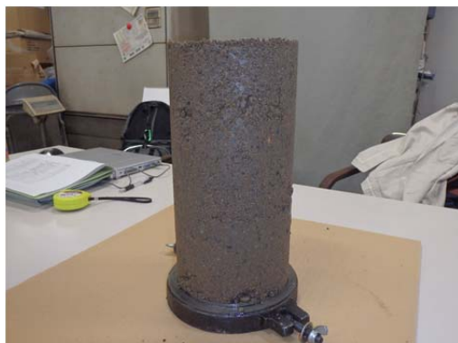
写真-2.1 配合試験供試体外観
