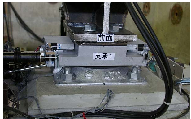
写真-9.2 支承の設置状況
