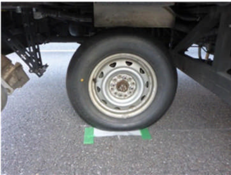
(上: すべり測定車第5輪、下: 測定風景近接)
