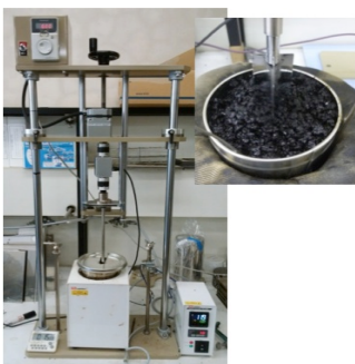
写真-4 混合性評価試験機
