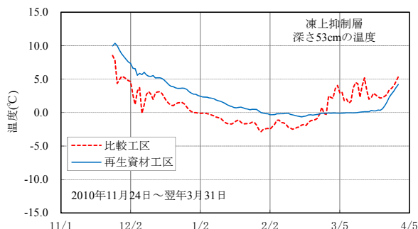
図-3-10 舗装体の温度(凍上抑制層)
