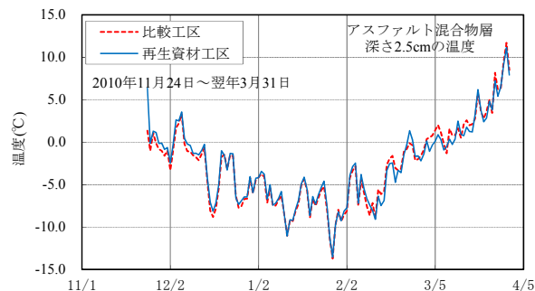
図-3-8 舗装体の温度 (アスファルト混合物層)
