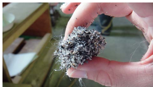
図-4.16 短繊維による砂粒子の緊縛状況 ( r_m=1.456\% )
