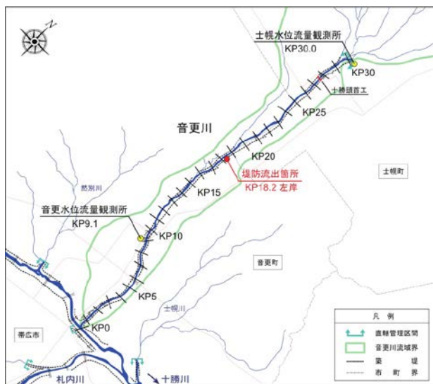
図-3.2 被災箇所（音更川 KP18.2 付近左岸側）
