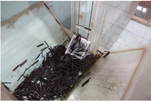
写真3.4 流木堆積状況（スクリーン有）
