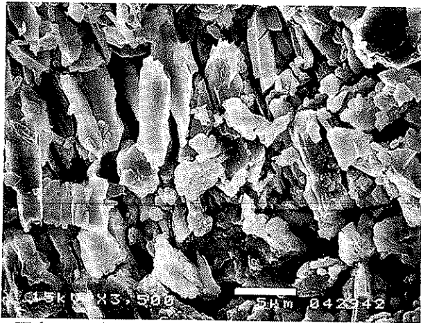
写真-2 粉状化した濁沸石結晶（SEM 画像）
