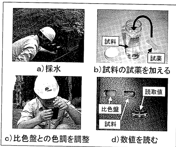
写真-9 テストキットによる鉄分濃度（全鉄）計測
