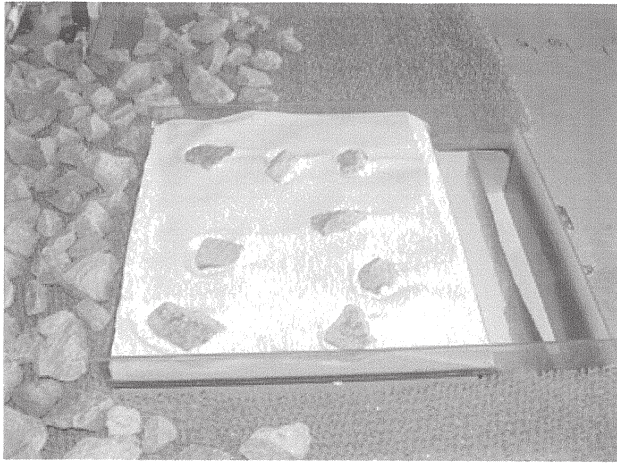
写真-4 砂利面積10%の発じん後の状態
