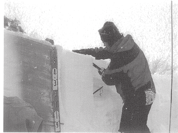
写真-1 弱層テスト実施状況 (雪柱上にのせたスコップを手で叩いている)
