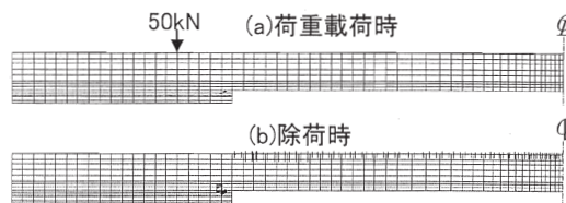
図 5.2.4 実桁の材料特性を反映したモデルによるひび割れ分布図(120mm はつり状態)
