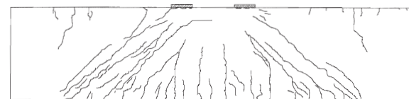
図-12 B17 供試体最大耐力時クラック図
