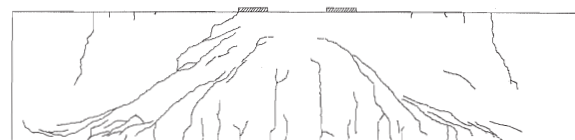
図-8 B14 供試体最大耐力時クラック図
