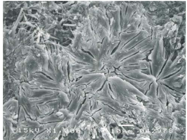
写真-13 黄鉄鉱含有泥岩粒を埋め込んだモルタル曝露試験体（屋外曝露）の電子顕微鏡観察で見られた放射状物質
