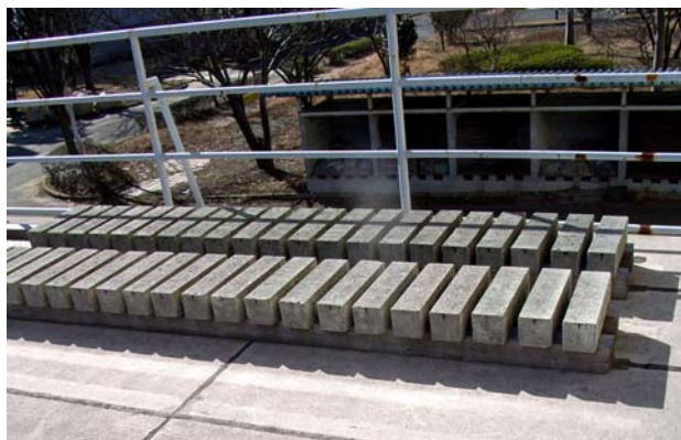
写真-1 黄鉄鉱含有コンクリート曝露試験 (屋外)
