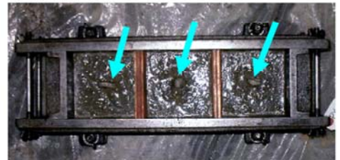
(5) 埋め込み用粒の設置(矢印) 埋め込み深さ50mm(立方体の中心に設置)
