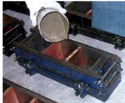
(3) 下半分のモルタル打設
