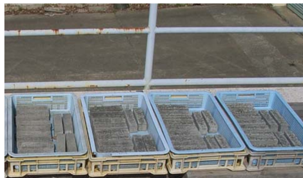
写真-2 黄鉄鉱含有モルタル曝露試験 (屋外)
