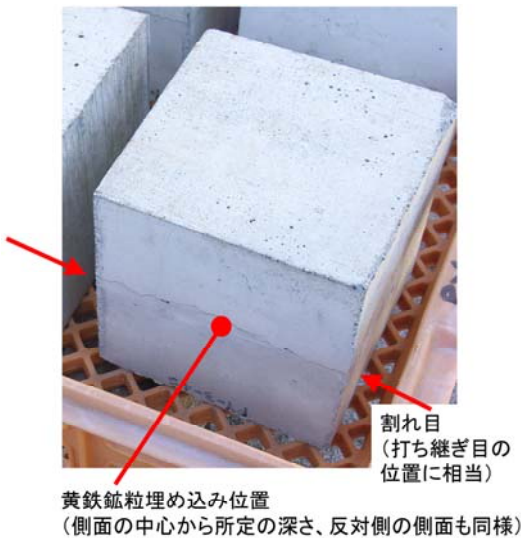
写真-4 黄鉄鉱粒を埋め込んだモルタル曝露試験体に生じた割れ目(屋外)
