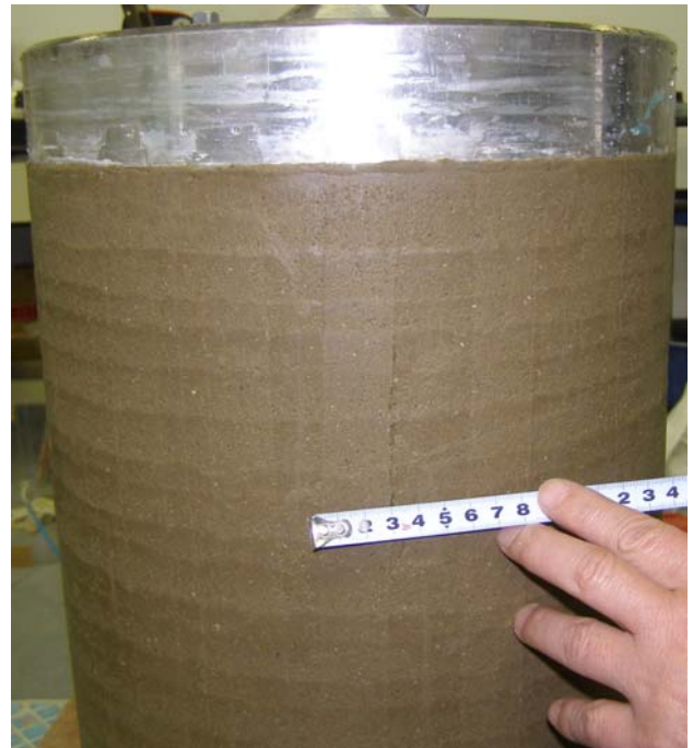
写真-3.3 供試体外側に発生した亀裂 (圧密応力 100kPa の場合) (スケールの3の数字の上に縦筋状のもの)
