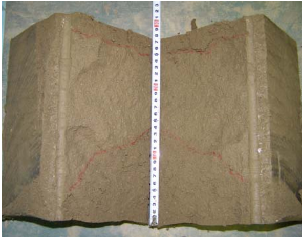
写真-3.5 水圧破碎した亀裂の範囲 (圧密応力 100kPa の場合) (赤い線で囲まれた範囲)
