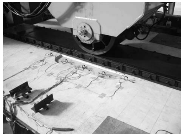
図-6 断面欠損部の荷重状況(供試体D)
