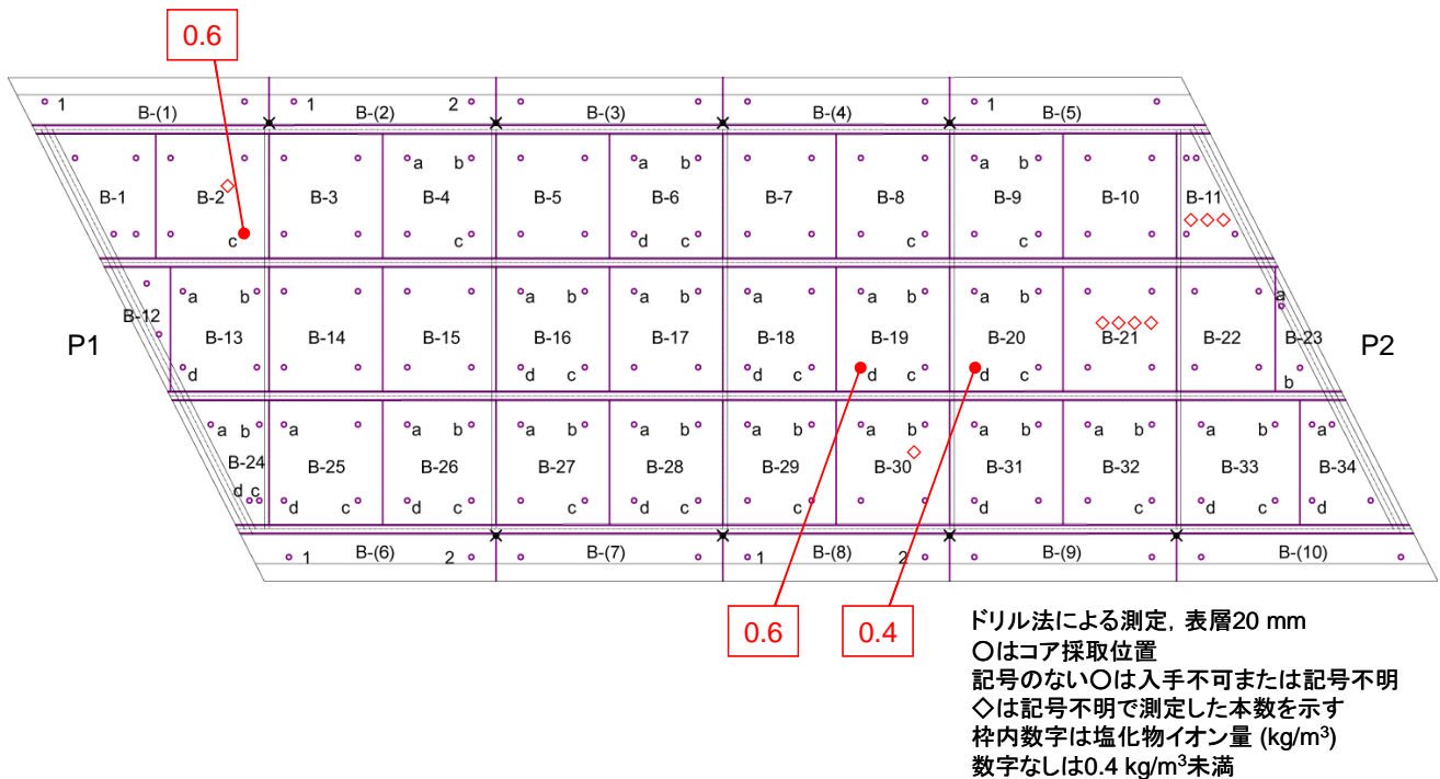
図-14 撤去時コア上面の塩化物イオン量 (TO 橋, P1-P2)
