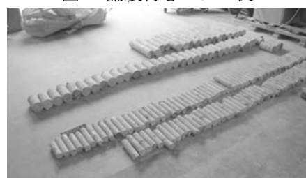
図-3 撤去時コア(AT 橋の例)
