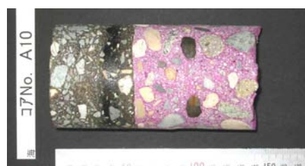
図-2 舗装付きコアの例
