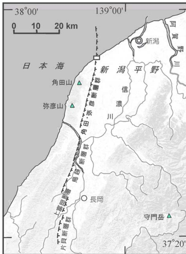
図-6 長岡平野西縁断層帯角田・弥彦断層群の分布と断層調査位置
