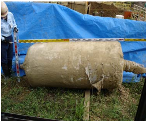
図17 アンカー体の出来形
