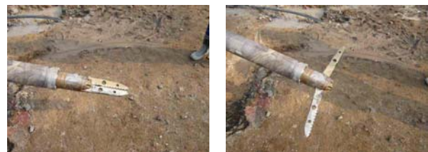
図 16 削孔ビット (左: 閉じた状態、右: 開いた状態)
