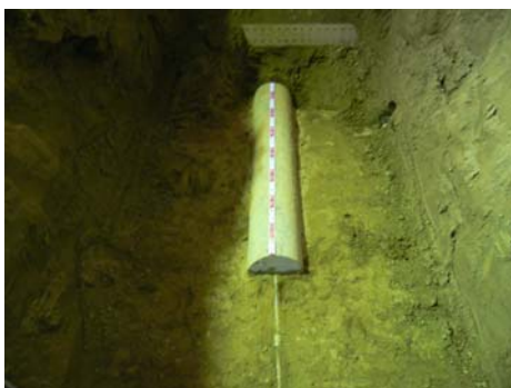
図 14 アンカー体模型 (φ500×L3000)
