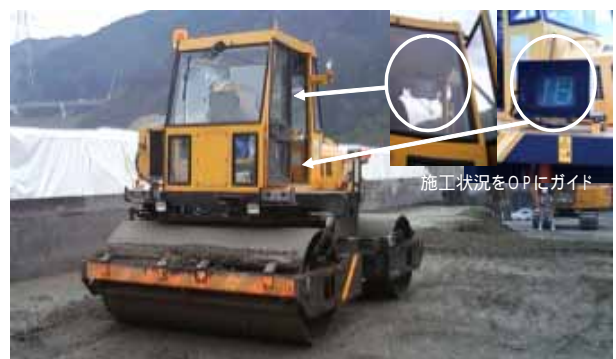
写真-2 振動ローラ(マシンガイダンス技術)
