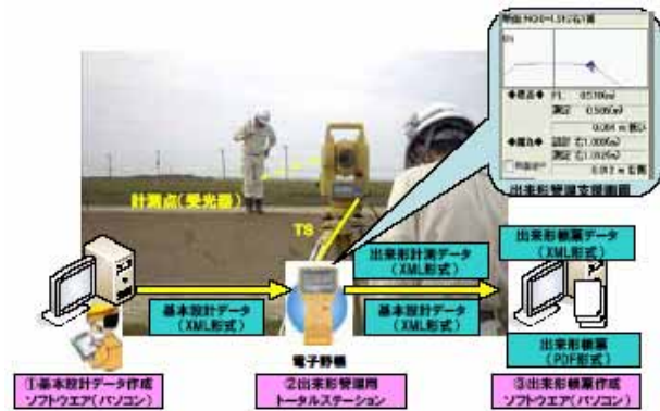
図-4 TS・GNSSを用いた出来形管理技術
