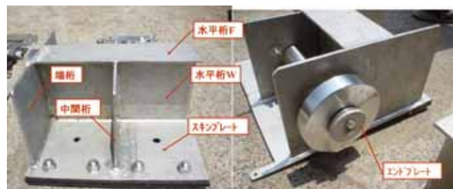
写真 - 7 暴露試験ユニット外観
