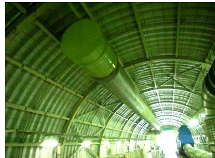
写真7 実験状況(特殊噴出管によるエアカーテン)
