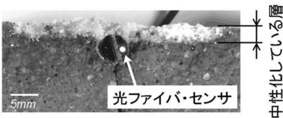
図 - 1 7 モルタル試験片の断面写真 (10mass%、50℃塩酸に 38 時間浸せき後)
