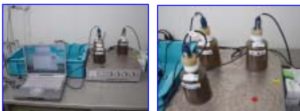
写真 - 1 底泥酸素消費速度試験
