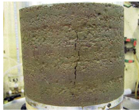
写真-3.1.3 発生したクラックの例 ( D_{max}=4.75\text{mm} 、 \phi=1.5\text{cm} 、 \sigma_3=392\text{kN}/\text{m}^2 、 \Delta p / \Delta t=98\text{kN}/\text{m}^2/\text{min} )
