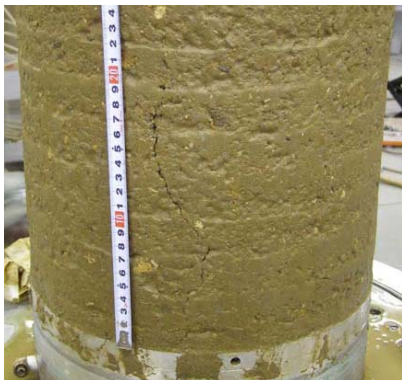
写真-3.2.3 クラックの発生状況例 (上:外側、下:内側) ( D_{max}=2mm 、 \sigma_3=196kN/m^2 )
