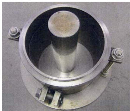
写真-3.1.1 供試体作製モールドとロッドの例 (ロッドの直径が5cmの場合)
