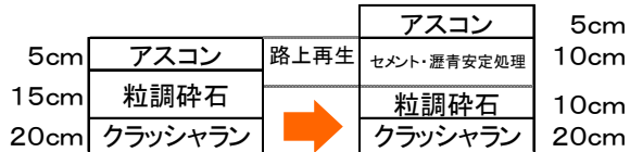
b) ケース⑥の工事内容
