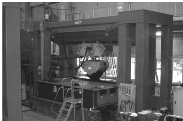
写真-1 輪荷重試験状況
