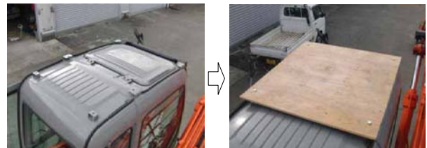
図2 コンパネ設置状況
