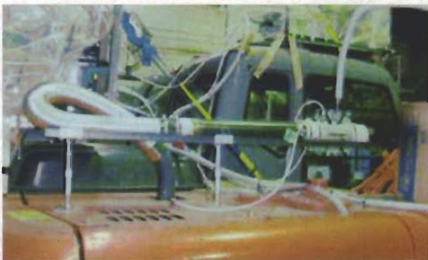
図4 排出ガス流量計設置状況
