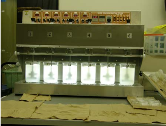
写真-2.3 ジャーテスターによる攪拌
