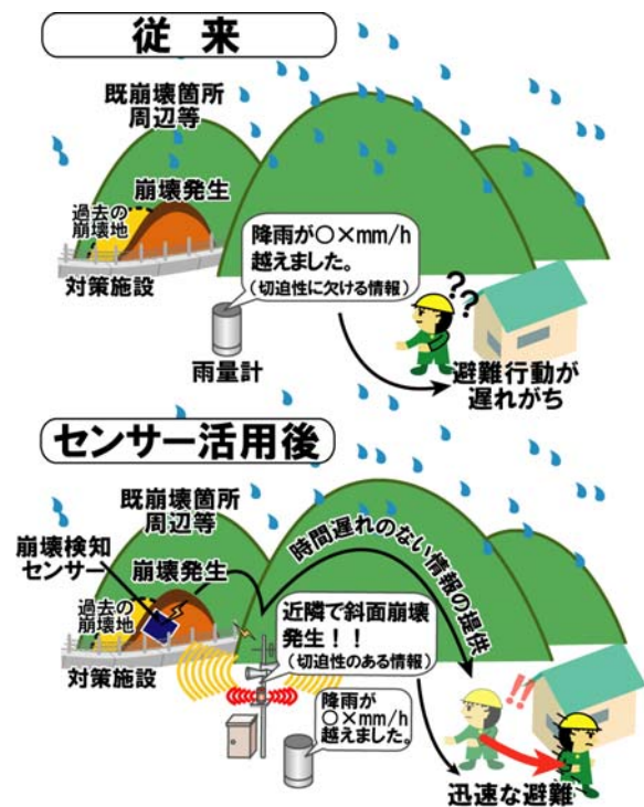
図-7 崩壊検知センサー活用イメージ
