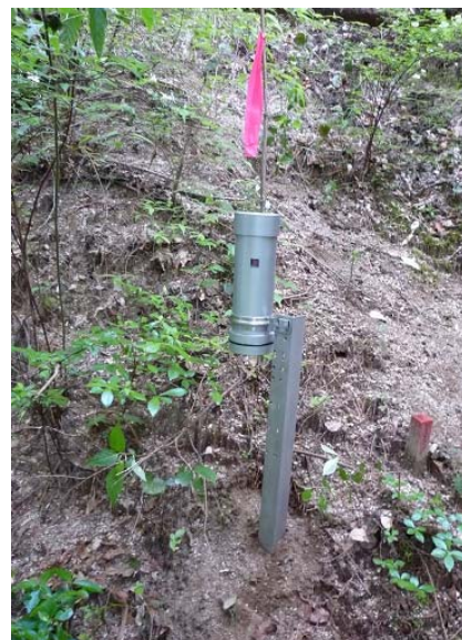
写真-1 斜面崩壊検知センサー
