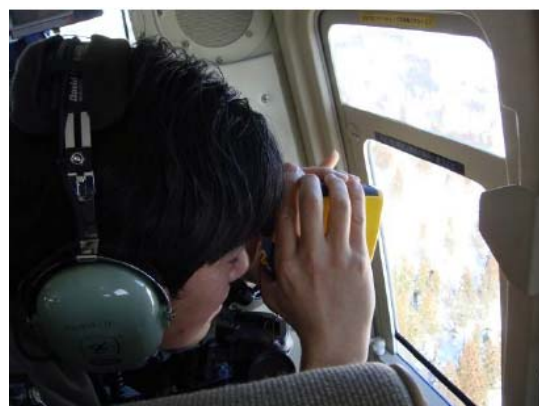
図-11 手持ちレーザー計測器の活用
