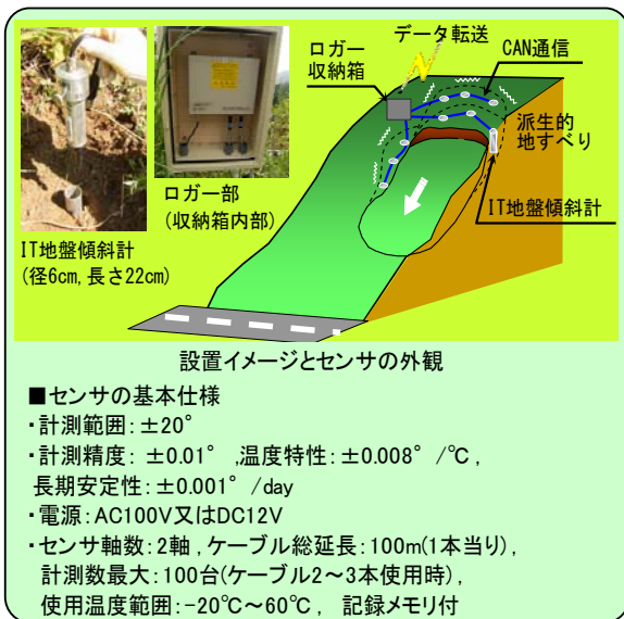
図-3.1 IT地盤傾斜計測システム
