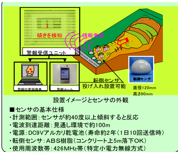
図-3.6 転倒式土塊到達検知システム
