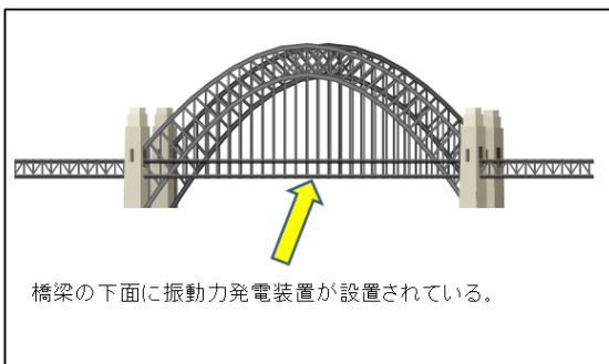
図-6 振動力発電装置設置箇所
