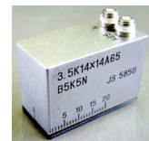
(b) 通常の斜角探触子 (3.5MHz、65 度、14×14mm)
