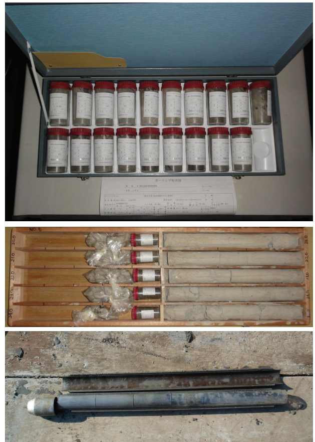
図-2 土質調査ボーリングにおけるコア試料採取・取扱い例。(上):部分ペネ試料のみ;(中):半コア+ペネ試料;(下):改良サンブラによるペネ試料採取例
