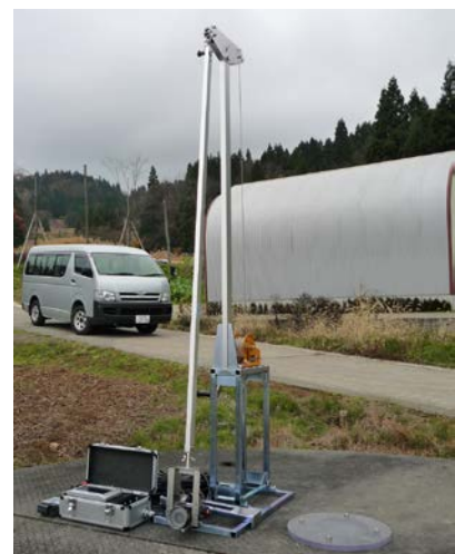
写真-8 集水井内点検用カメラ
