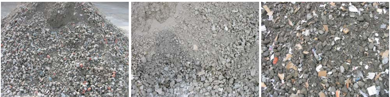
写真-1 異物混入後の路盤材の状況 (左: AB5%, 中央: CD1%, 右: EF5%)
