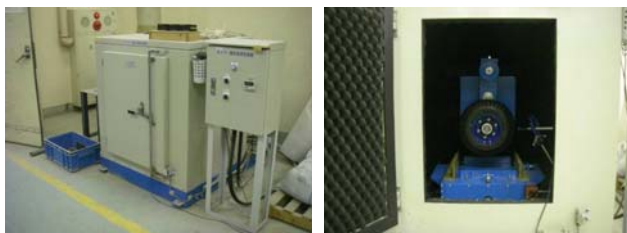
写真-5 タイヤ/路面騒音測定装置 (左: 外観, 右: 内部)
