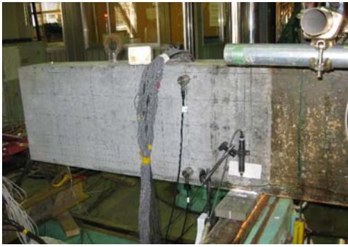
図-1 AE センサ設置状況
