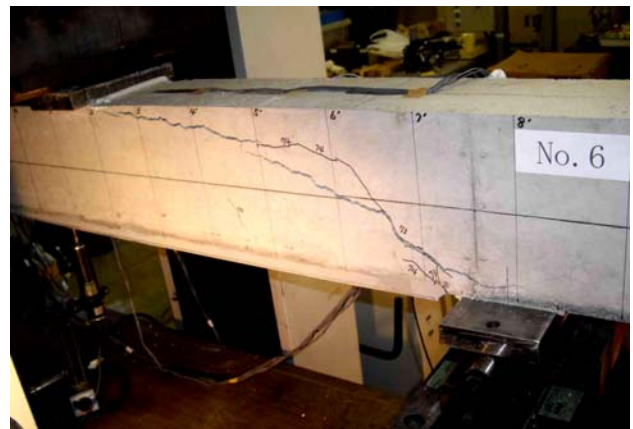
図-1 下面鋼板接着された RC 桁の載荷試験
