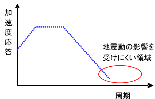
図-1 構造物の固有周期と加速度応答
