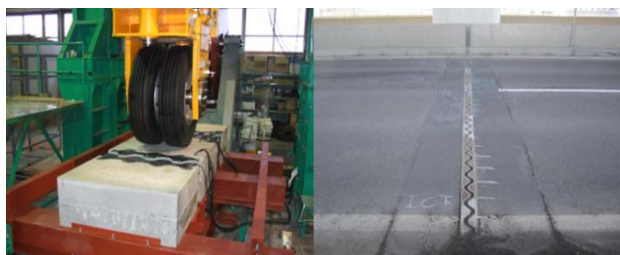
写真Ⅲ-4：輪荷重走行試験および現地試験施工の状況
