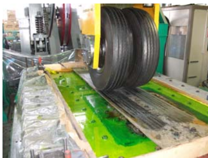
写真 II-4 輪荷重走行載荷試験状況(水張り)
