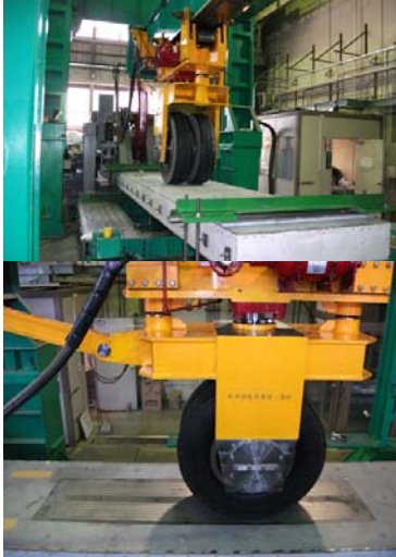
写真 I-7 輪荷重走行載荷試験状況
