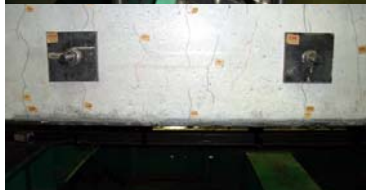
写真 I-8 試験後供試体のクラック発生状況
