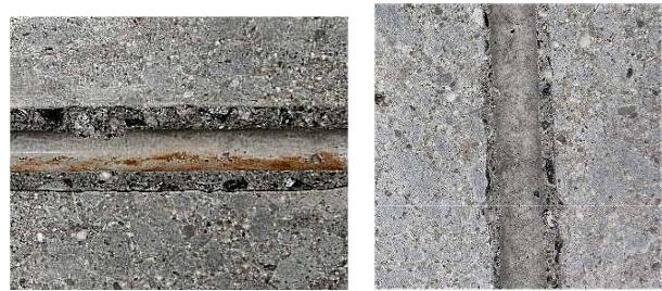
写真-1 鉄筋取り外し後の供試体状況 (左: NS-Rb-50 右: NC-R2b-50)
