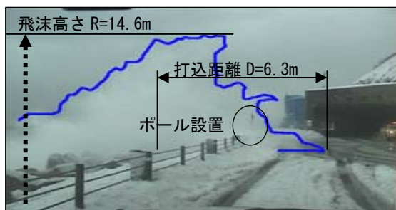
写真-5 越波観測状況
