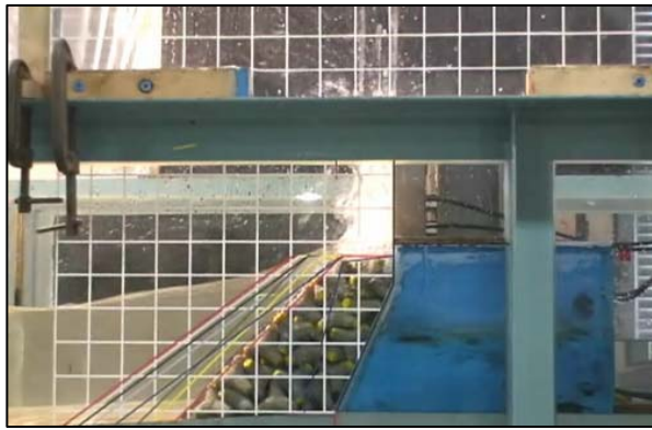
写真-17 波圧実験状況の例 (A 護岸)
