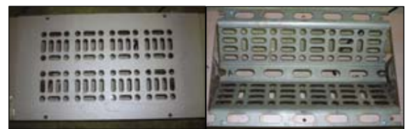
写真-11 計測板 \varepsilon=30\% (左：平板、右：折板)
