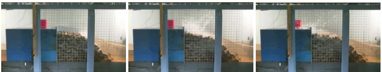
写真-3 越波飛沫の飛散状況 ( T_{1/3}=11.0\text{s} 、 H_0'=3.0\text{m} )
